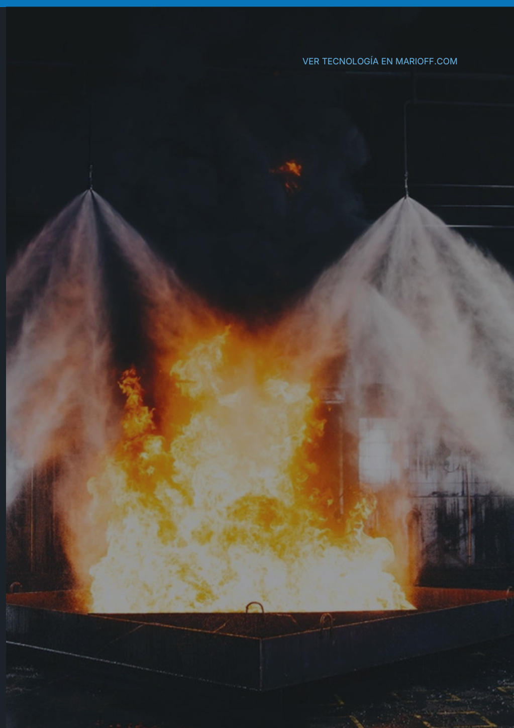
ENSAYO DE AGUA NEBULIZADA · MARIOFF
